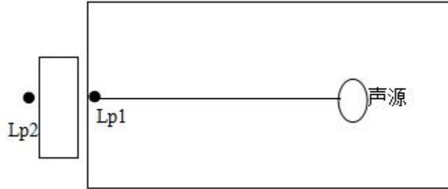
图 4-1 室内声源等效为室外声源图例
