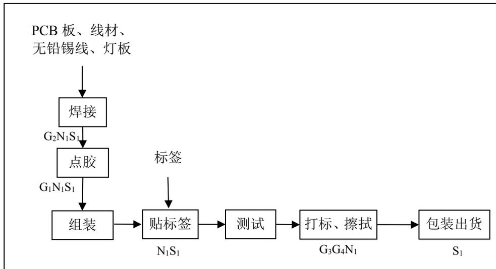
图 2-2 生产工艺流程图 2
