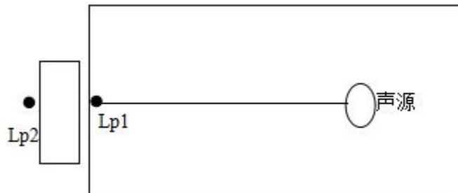
图 4-1 室内声源等效为室外声源图例
