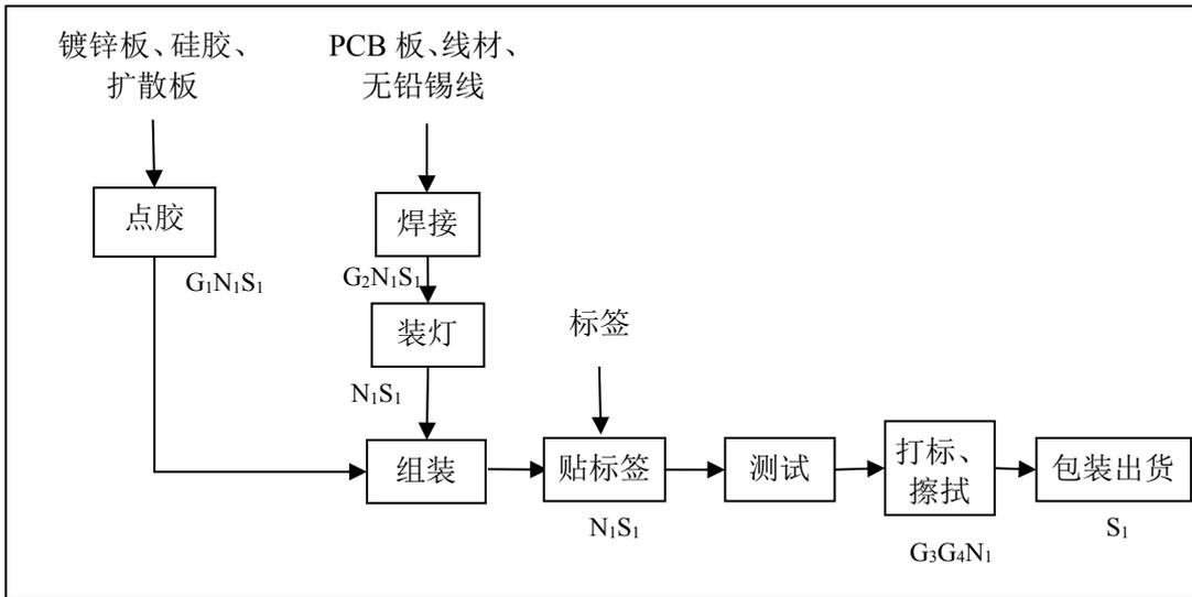
图 2-1 生产工艺流程图 1
