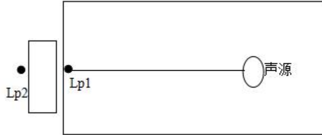
图 4-1 室内声源等效为室外声源图例
