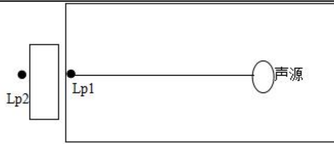
图 4-2 室内声源等效为室外声源图例
