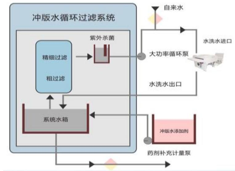
图 4-1 项目工业废水处理工艺流程图
