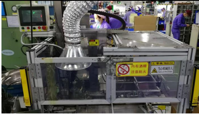
图 4-1 酒精工位集气罩（打磨机，压入机类似）
