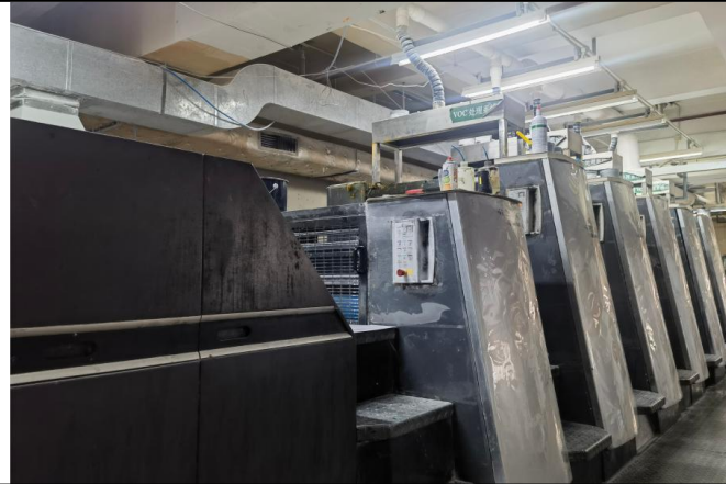
2楼印刷工位及印刷废气收集装置
